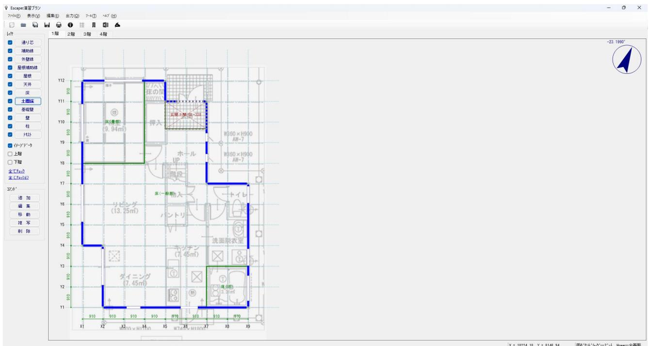
入力した基礎壁を削除するには、基礎壁レイヤを選択し、削除ボタンをクリックして削除対象の基礎壁をマウスで指示します。基礎壁の移動・複写はできません。
