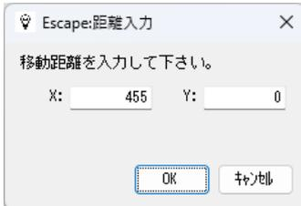
複数選択により複数部材の移動(複写)を行うには、デザイナメニューのメニューバーから「編集」→「複数選択」→「移動(複写)」を選択します。次に、移動(複写)したい部材を1つずつマウスで選択し、選択が完了したらマウスの右ボタンをクリックして、移動(複写)距離を入力するダイアログを表示します。なお、一旦選択した部材を除外するには再度その部材をクリックして下さい。
