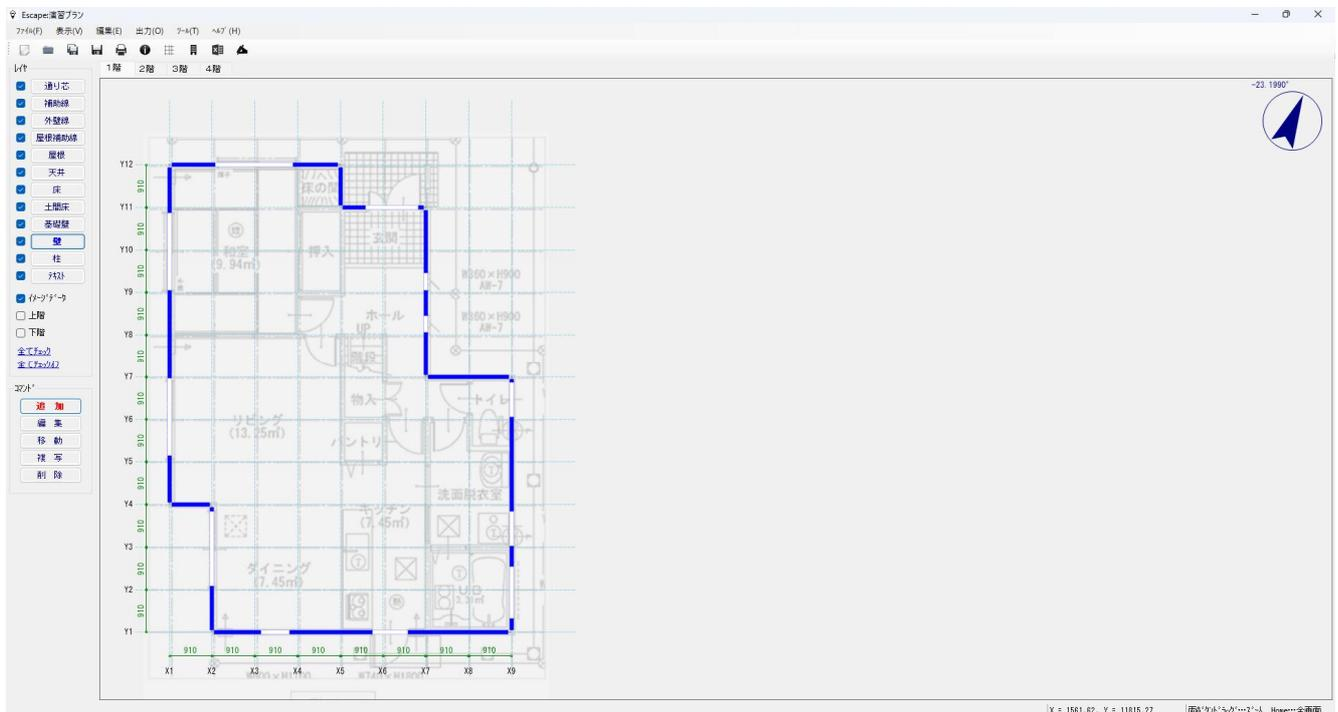
入力した外壁を削除するには、壁レイヤを選択し、削除ボタンをクリックして削除対象の壁をマウスで指示します。壁の移動・複写はできません。
