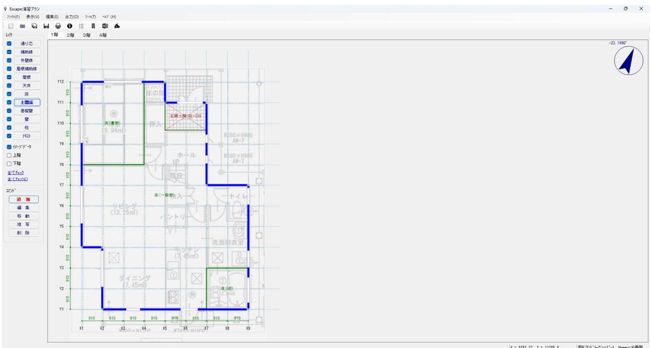
入力した土間床を削除するには、土間床レイヤを選択し、削除ボタンをクリックして削除対象の土間床をマウスで指示します。土間床の移動・複写はできません。
