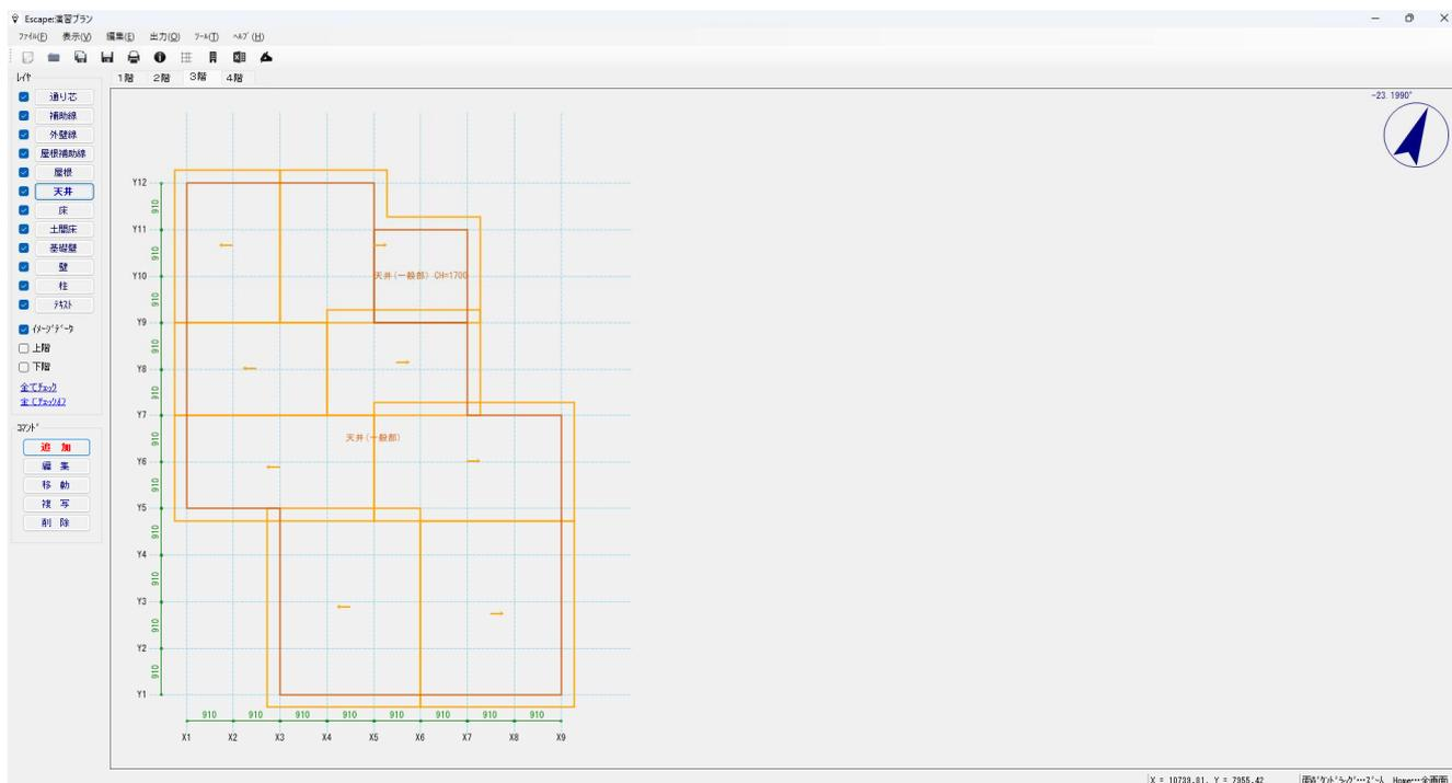
入力した天井を削除するには、天井レイヤを選択し、削除ボタンをクリックして削除対象の天井をマウスで指示します。天井の移動・複写はできません。
